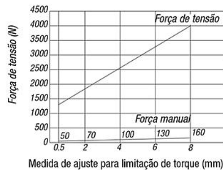
Grampo de fixação com força de aperto para baixo K0928.0800 para baixo K0928.0801
