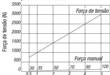
Medida de ajuste para limitação de torque (mm)
