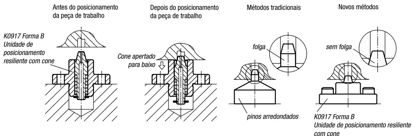
Ao colocar a peça de trabalho na unidade de posicionamento, o cone será movimentado para baixo.
